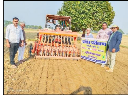
फोटो: 1 सुपर सीडर से धान कटनी के बाद गेहू की सीधी बुआई
