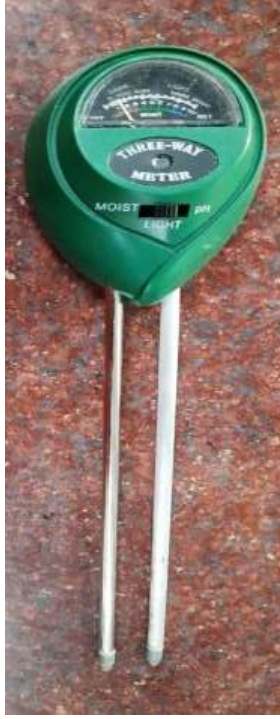
चित्र (7) मिट्टी की नमी, पीएच और विकिरणप्रकाश मापने का उपकरण
